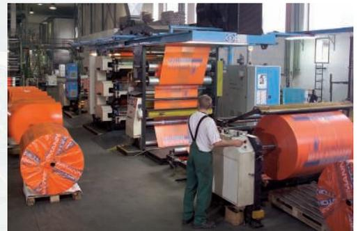
8 - Farben - Flexodruckmaschinen im Einsatz
