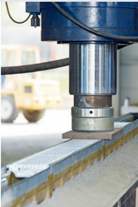
Prüfung der Dichtheit nach Langzeitsimulation
