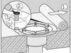
Bei einlagigen Dichtungsbahnen oder Dichtungsbahnen mit einer Dicke unter 2 mm empfehlen wir, Flanschdichtungen oberhalb und unterhalb der Dichtungsbahn zu verwenden, oder die Dichtungsbahn mehrlagig zu verlegen.
