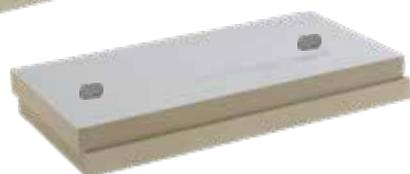
Sofern keine Brandschutzanforderungen z. B. nach DIN 18234 vorliegen, kann die Anzahl der Befestiger bei Großflächenplatten von 6 auf 5 reduziert werden. Bitte beachten Sie die werkseitige Kennzeichnung der Plattenober- bzw. Rückseite.
