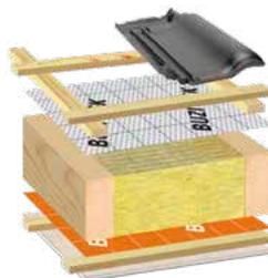
**Verklebte Unterdeckung auf Wärmedämmung oder Holzschalung**
