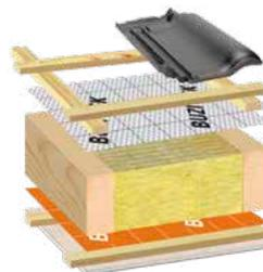
**Überlappte Unterdeckung auf Wärmedämmung oder Holzschalung**
