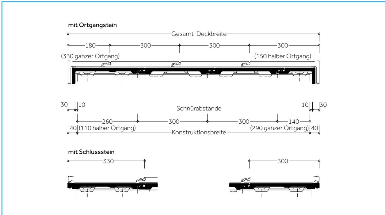
Konstruktionsbreite = jeweils Schnürabstand Ortgang rechts + Dachsteine + Halber Dachstein + Ortgang links
