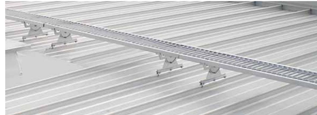
Je Endlos-Laufrost werden zwei Laufrosthaltungen benötigt. Der maximale Abstand beträgt 120 cm. Die Elemente sind endlos mit Steckverbindungen erweiterbar und sind im Lieferumfang enthalten.
