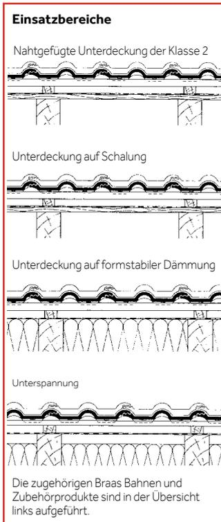
Mit Divoroll Top RU/ Maximum RU und dem entsprechenden Systemzubehör kann eine regensichernde Zusatzmaßnahme der Klasse 2 hergestellt werden (siehe Verlegehinweise Zusatzmaßnahme nahtgefügte Unterdeckung der Klasse 2).
