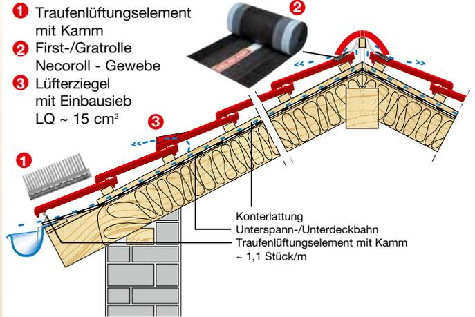
Die genannten Lüftungsquerschnitte haben sich in der Praxis bewährt und werden lt. Fachregeln für Dachdeckungen empfohlen. (in Anlehnung DIN 4108-3)
