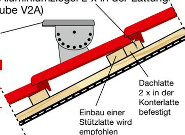
Gleiches gilt für Alu-Pfannen mit Schneefangstütze oder Rundholzhalterung. Stützlatte sind hier jedoch nicht erforderlich. Bei erhöhten Anforderungen sollte zudem der Stützenabstand verringert werden (60 cm).
