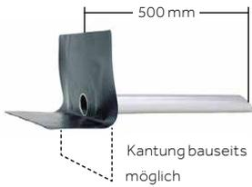
Der Wasserspeier ist besonders gut geeignet für die Entwässerung von Balkonen und Kleinflächen. Materialstärke 0,7 mm, Rohrlänge 500 mm, Edelstahl-Verbundblechflansch und Bahnenflansch. Erhältlich mit einem Wolfjin oder einem universellen, grauen Bahnenflansch.
