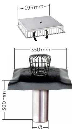
Erhältlich mit einem Wolfin oder einem universellen, grauen Bahnenflansch. Materialstärke 0,7 mm, Rohrlänge 300 mm für Dämmstoffdicken von 115 bis 230 mm, passend für Grundelement oder Rohr mit Muffe. Kombinierbar mit Kiesfang SD für höhere Ablaufleistungen.
