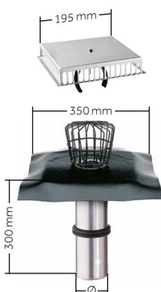
Erhältlich mit Wolfin Bahnenflansch, Materialstärke 0,7 mm, Rohrlänge 300 mm, Eintauchtiefe in vorhandenens Gullysystem/Rohr mind. 70 mm, passend für ein Rohr ohne Muffe. Kombinierbar mit Kiesfang SD für höhere Ablaufleistungen.
