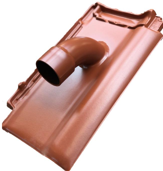
Der Rhedach Solardurchgang ist für diverse Durchgangsleitungen einzusetzen, immer zum Eindeckmaterial passend lieferbar. Der Solardurchgang wird aus einem original Ziegel-/Dachsteinmodell mit einem farblich abgestimmten Bogen hergestellt. Die Eindeckung erfolgt also homogen zur Flächenziegel.
