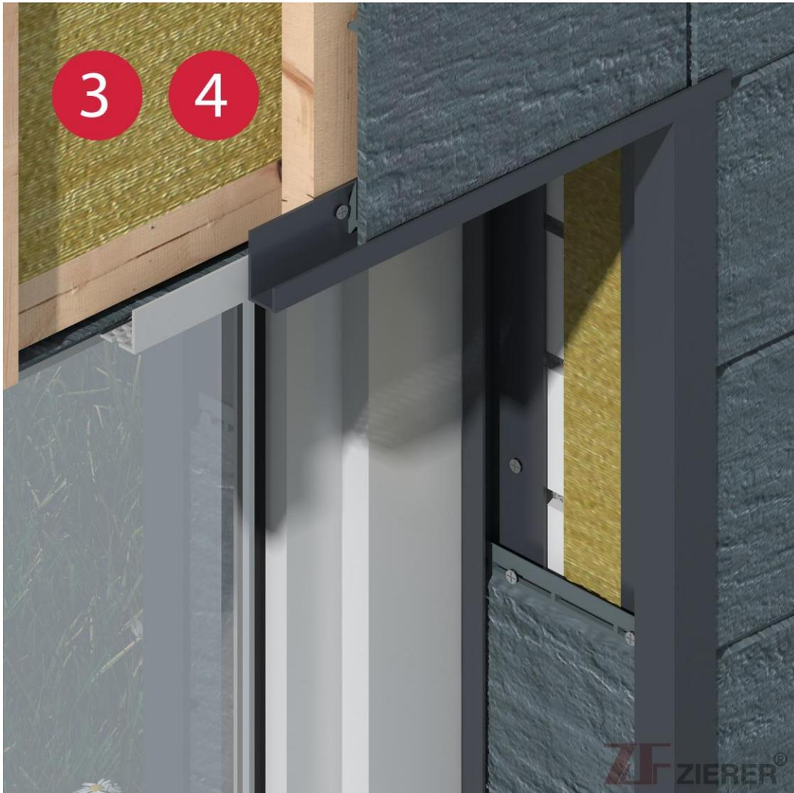
Eckprofil in der Verwendung mit dem U-Profil zum Anschluss an einen Fensterrahmen. Im Sturzbereich über dem Fenster wird zusätzlich ein Lüftungsprofil, ( untere Lüftung ) eingebaut.
