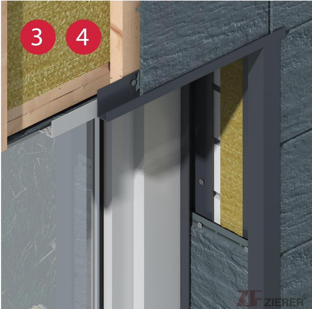
Das U-Profil wird als Anschluss an einen Fensterrahmen montiert. Im Sturzbereich über dem Fenster wird zusätzlich ein Lüftungsprofil, ( untere Lüftung ) eingebaut.
