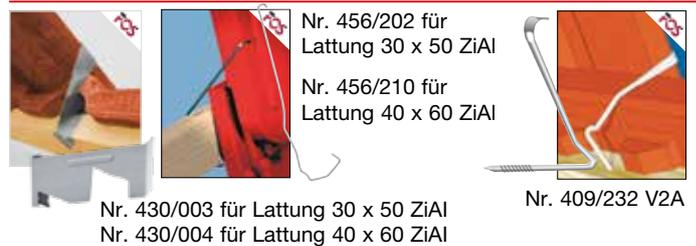
Entsprechend den Fachregeln liefern wir Sturmklammern für die einfache und effektive Windsogsicherung. Alternativ zum Verkleben mit der Lattung oder zum Einschlagen in die Lattung. Korrosionsbeständig durch Edelstahlradht 1.4310 (A2) oder ZIAL®-Beschichtung (Korrosionsschutz).
