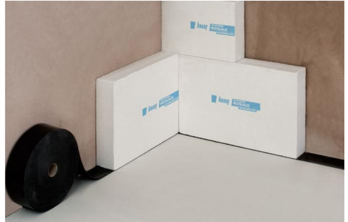
Vor dem Verkleben der ersten Dämmplatte wird auf dem Fußboden und unter der Decke ein Knauf Dichtungsband aufgebracht. Um eine Lufthinterströmung zu vermeiden, ist bei Unebenheiten zusätzlich ein Knauf Fugendichtband FD anzuordnen.
