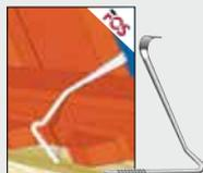
Entsprechend den Fachregeln liefern wir Sturmklammern für die einfache und effektive Windsogsicherung. Alternativ zum Verkleben mit der Lattung oder zum Einschlagen in die Lattung. Korrosionsbeständig durch Edelstahl draht 1.4310 (A2) oder ZIAL®-Beschichtung (Korrosionsschutz).
