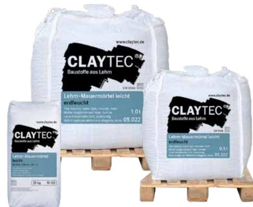
Mauermörtel für leichte Lehmsteine bei Fachwerkausfachung und Innenschalen. Durch die Holzspananteile wird die Anpassung an die Materialzusammensetzung der leichten Lehmsteine erreicht, auch die Rohdichte und die bauphysikalischen Eigenschaften werden so angepasst. Die Sackware (Trockenmörtel) ist unbegrenzt haltbar.
